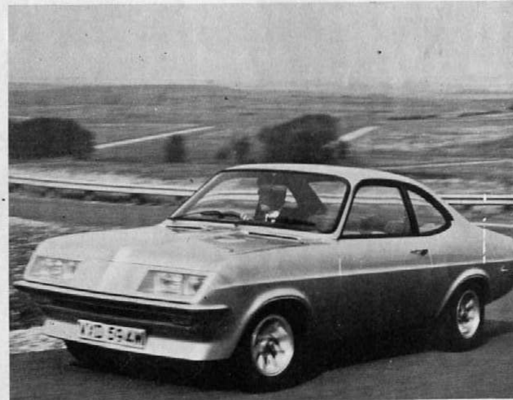
Un'altra immagine della Vauxhall Firenze con motore 2300, caratterizzata dalla nuova parte frontale ad alto coefficiente aerodinamico. I quattro fari carenati hanno lampade alogenate, mentre la vettura è offerta in un solo colore, argento. Velocità massima circa 200 kmh
