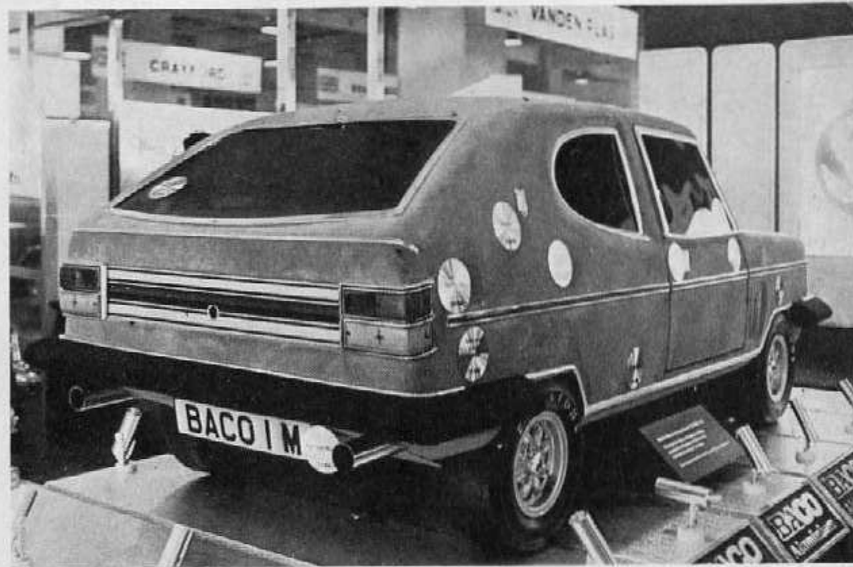
Al salone, nello stand della British Aluminium Company c'era questo simulacro di vettura con placchette che identificavano i tanti particolari di una moderna autovettura che vengono costruiti in alluminio
