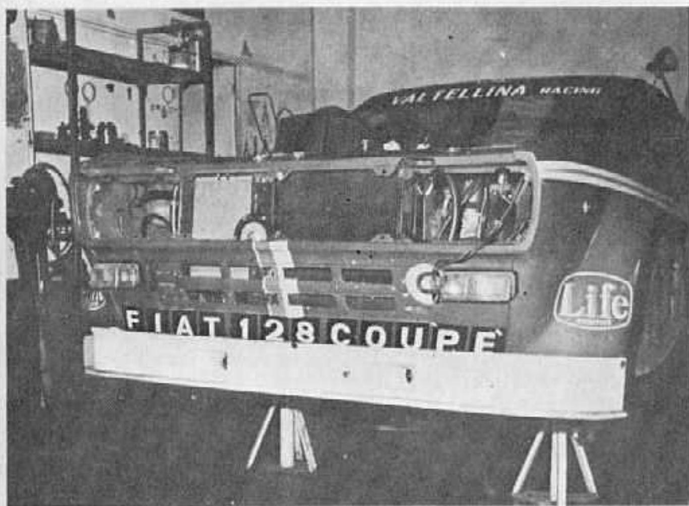
Il muso della Fiat 128 della Valtellina Racing è stato modificato con l'applicazione di uno spoiler con bordo deportante
