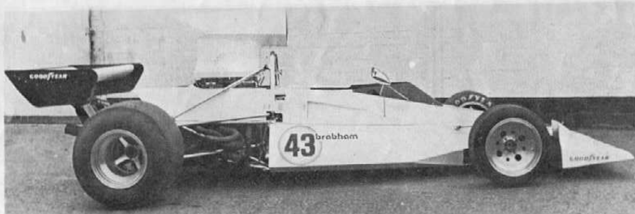
Anche la Brabham ha sfornato in questi giorni la sua F. 5000, con la sigla B 43; vediamo in alto la ridottissima sezione frontale, qui sopra la tradizionale monoscocca a sezione triangolare tipo Formula 1 e a destra il profilo
