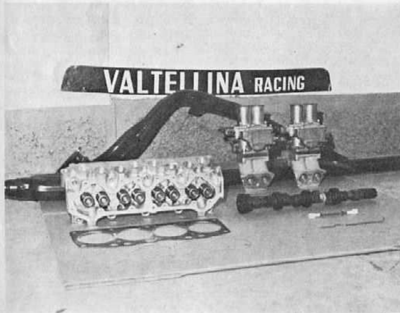
Sopra, i componenti del kit stradale da 115 CV, comprendente anche un albero a cammes. Sotto, blocco motore in lavorazione
